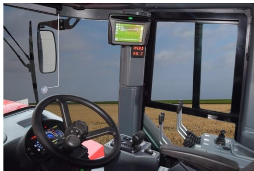
Автоматизированная КП «Т5» и система управления КОМАНДПОСТ, гидравлический автопилот от Тримбл
