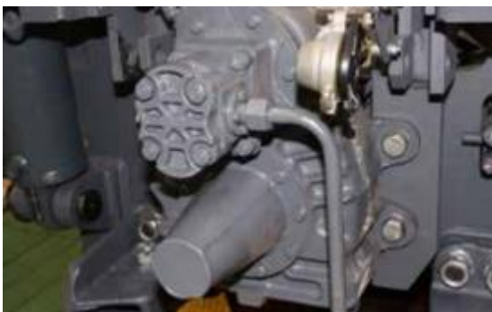
МOM со сменными хвостовиками, 540 и 1000 об/мин
